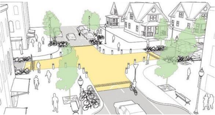
Fig.75.Intersection surélevée Source : NACTO
