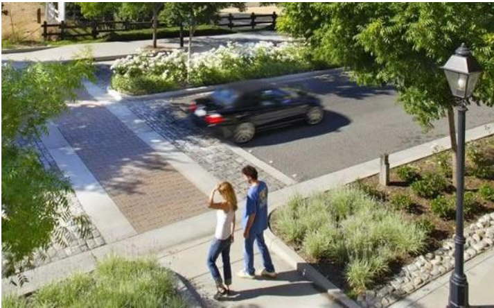
Fig.74.Traverse piétonne surélevée, Santa Monica, É-U. Source : RRM Design Group
