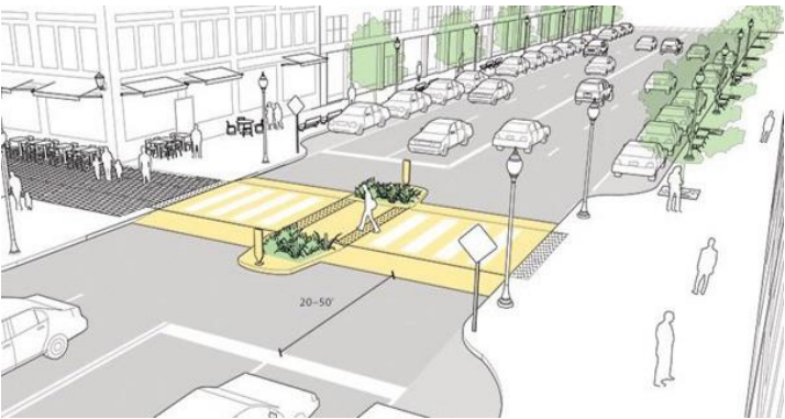
Fig.76.Passage surélevé au centre d'un îlot Source : NACTO
